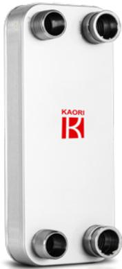
Für eine Verhinderung der Vermischung von zwei Flüssigkeiten bei inneren Leckage, KAORI konzipierte D Serie mit gestapelten Platten, um die Möglichkeit von Kreuzkontamination zu beseitigen. Der einzelne Luftspalt wird bei zwei Platten geschaffen. Wenn es innere Leckage erfolgt, wird die zweite Platte einer Abschirmung für die Flüssigkeiten zu erhalten und in gleichen Kanal durch den Luftspalt fließen. Das Design kann man einfach die Leckage finden.
