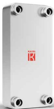
塩素イオン濃度が高く、また使用圧力が高い場合に適しております。M シリーズは腐食に強いステンレスプレート (SMO254) を使用。またプールや腐食性のある流体を使用するヒートポンプに適しております。
