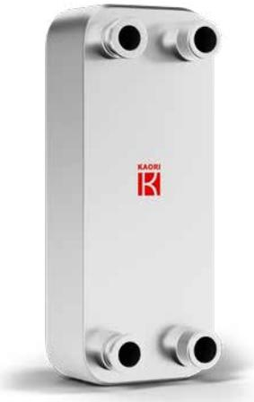
KAORIのDシリーズは2つの流体の混入を防止するために設計した新型熱交換器です。プレートとプレートの間に空間を作る事により万が一伝熱プレートが破損しても流体はプレート同士の隙間を通り外部に漏れる為、流体同士の混入を未然に防ぐ事が出来ます。
