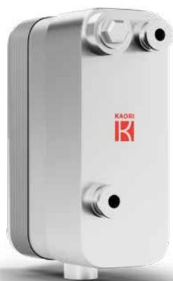
エアドライヤー専用熱交換器はコンパクトな設計だけではなく、熱伝導率も高く、予冷熱交換器、エバポレーター、ドレン分離機能を備えた一体型熱交換器で圧縮空気中の水分を完全に除去できるだけでなく、自の技術で理想的なドレン分離機構を採用しており目詰まりを起さない構造になっています。このドレン分離機はエアドライヤーに不可欠なものです。
